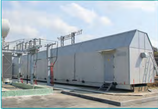
Модуль распределительного устройства 25 кВ Выпускается в типоразмерах модулей 6 и 4,8 м. количество шкафов в блоке для модуля типоразмером 6 м – до 3 шт.; для модуля 4,8 м – до 2 шт. Подключение – кабельное или шинное.
