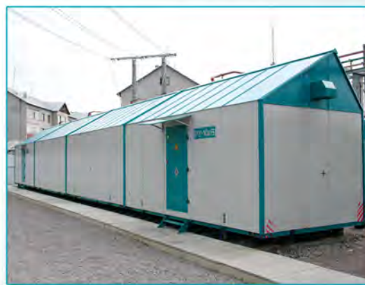
Модуль распределительного устройства 6 (10) кВ Выпускается в типоразмерах модулей 6 и 4,8 м. Максимальное количество шкафов серии "Омега" в блоке для модуля типоразмером 6 м – до 7 шт.; для модуля типоразмером 4,8 м – до 5 шт. Подключение для модулей с шкафами серии "Омега" – кабельное или шинное.
