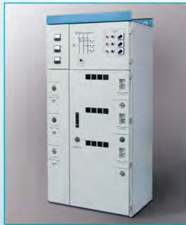
Комплектное распределительное устройство постоянного тока отрицательной шины РУОШ-600 В Одностороннее обслуживание, внутренняя установка, воздушная изоляция, с током главных цепей до 2000 А.
