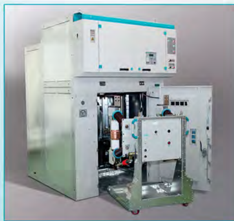
Комплектное распределительное устройство переменного тока на напряжение 25 кВ серии "1С-25" Одностороннее обслуживание, внутренняя установка, воздушная изоляция, использование вакуумных одно-, двух- и трехполюсных выключателей серии ЗАН с током главных цепей до 2000 А.
