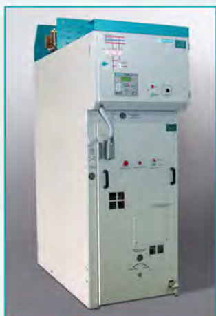
Комплектное распределительное устройство постоянного тока на напряжение 3,3 кВ серии "КВ-3,3" Одностороннее обслуживание (уменьшенный габарит), внутренняя установка, воздушная изоляция, использование выкатных выключателей серии ВАБ-206 с током главных цепей до 6300 А.
