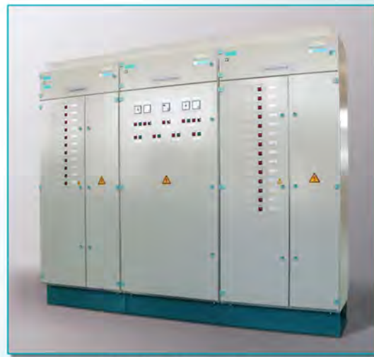
Функциональные блоки собственных нужд постоянного тока Одностороннее обслуживание, внутренняя установка. Номинальный постоянный ток главных цепей до 630 А, номинальное напряжение постоянного тока до 220 В.
