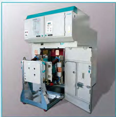
Комплектное распределительное устройство переменного тока на напряжение 2x25 кВ серии "1С-2x25" Одностороннее обслуживание, внутренняя установка, воздушная изоляция, использование вакуумных одно- и двухполюсных выключателей серии ЗАН с током главных цепей до 2000 А.
