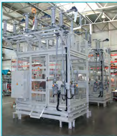
Блоки открытых распределительных устройств переменного тока на напряжение до 35 кВ Наружная установка, воздушная изоляция, использование вакуумных выключателей серии ВБС или ВВН с током главных цепей до 2000 А.
