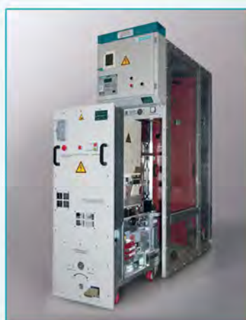
Комплектное распределительное устройство постоянного тока на напряжение 600 В серии "КВ-600" Одностороннее обслуживание (уменьшенный габарит), воздушная изоляция, использование выкатных выключателей серии ВАБ-209, ВАБ-211 с током главных цепей до 4000 А.
