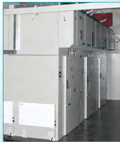
Функциональные блоки распределительного устройства 35 кВ Одностороннее обслуживание, внутренняя установка. Выполнены на базе шкафов серии 1С-35 или аналогичных. Ток главных цепей блока до 2000 А. Количество шкафов в блоке – до 3 шт.
