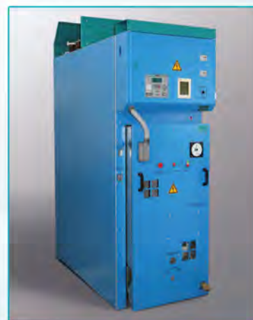
Комплектное распределительное устройство постоянного тока на напряжение 825 В серии "КВ-825" Одностороннее обслуживание (уменьшенный габарит), внутренняя установка, воздушная изоляция, использование выкатных выключателей серии ВАБ-206, Gerapid с током главных цепей до 8000 А.
