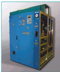
Комплектное распределительное устройство постоянного тока на напряжение 825 В серии "ТС-825" Одностороннего обслуживания, с воздушной изоляцией, с использованием стационарно установленных выключателей серии ВАБ-206, ВАБ-49 с током главных цепей до 6300 А.
