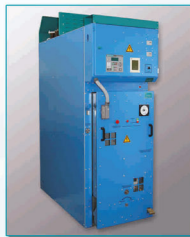
Комплектное распределительное устройство постоянного тока на напряжение 825 В серии "КВ-825" Одностороннего обслуживания (уменьшенного габарита), внутренней установки, с воздушной изоляцией, с использованием выкатных выключателей серии ВАБ-206 с током главных цепей до 6300 А.
