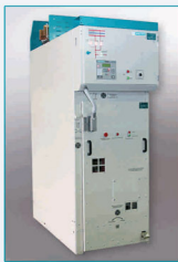
Комплектное распределительное устройство постоянного тока на напряжение 3,3 кВ серии "КВ-3,3" Одностороннего обслуживания (уменьшенного габарита), внутренней установки, с воздушной изоляцией, с использованием выкатных выключателей серии ВАБ-206 с током главных цепей до 6300 А.
