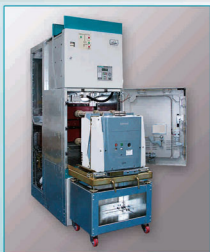
Комплектное распределительное устройство на напряжение 6, 10 и 20 кВ на базе КСО "Микрон" или КРУ "ОМЕГА" Одностороннего обслуживания, внутренней установки, с воздушной изоляцией, с использованием вакуумных выключателей ISM15 (6, 10 кВ), ISM25 (20 кВ), VF12 (6, 10 кВ) или SION с током главных цепей до 3150 А (6, 10 кВ) и до 2500 А (20 кВ).
