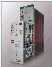
Комплектное распределительное устройство постоянного тока на напряжение 600 В серии "КВ-600" Одностороннего обслуживания (уменьшенного габарита), с воздушной изоляцией, с использованием выкатных выключателей серии ВАБ-209, ВАБ-211 с током главных цепей до 4000 А.
