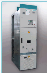
Комплектное распределительное устройство на напряжение 6, 10 и 20 кВ на базе КСО "Микрон" или КРУ "ОМЕГА" Одностороннего обслуживания, внутренней установки, с воздушной изоляцией, с использованием вакуумных выключателей ISM15 (6, 10 кВ), ISM25 (20 кВ), VF12 (6, 10 кВ) или SION с током главных цепей до 3150 А (6, 10 кВ) и до 2500 А (20 кВ).
