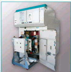
Комплектное распределительное устройство переменного тока на напряжение 2x25 кВ серии "IC-2x25" Одностороннего обслуживания, внутренней установки, с воздушной изоляцией, с использованием вакуумных одно- и двухполюсных выключателей серии ЗАН с током главных цепей до 1250 А.
