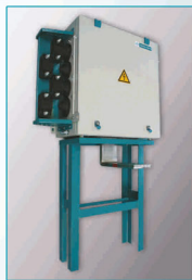
Шкаф подключения кабеля ШПК-825 В Наружной и внутренней установки, до IP55, до 5000 А.
