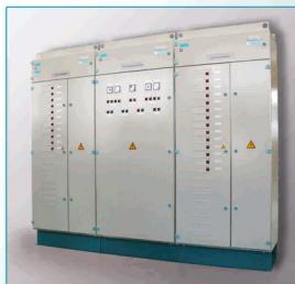
Функциональные блоки собственных нужд постоянного тока Одностороннего обслуживания, внутренней установки. Номинальный постоянный ток главных цепей до 630 А, номинальное напряжение постоянного тока до 220 В.
