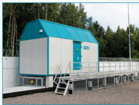
Модуль распределительного устройства 35 кВ Выпускается в типоразмерах модулей 6 и 4,8 м. Максимальное количество шкафов в блоке в модуле – до 6 шт. Подключение – кабельное.
