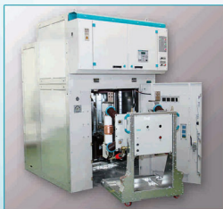
Комплектное распределительное устройство переменного тока на напряжение 27,5 кВ серии "IC-27,5" Одностороннего обслуживания, внутренней установки, с воздушной изоляцией, с использованием вакуумных одно-, двух- и трехполюсных выключателей серии ЗАН с током главных цепей до 2000 А.
