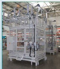
Блоки открытых распределительных устройств на напряжение 27,5 кВ Наружной установки, с воздушной изоляцией, с использованием вакуумных выключателей серии ВБС или ВВН с током главных цепей до 2000 А.
