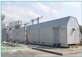
Модуль распределительного устройства 27,5 кВ Выпускается в типоразмерах модулей 6 и 4,8 м. количество шкафов в блоке для модуля типоразмером 6 м – до 3 шт.; для модуля 4,8 м – до 2 шт. Подключение – кабельное или шинное.
