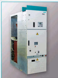
Комплектное распределительное устройство на напряжение 6, 10 и 20 кВ на базе КСО "Микрон" или КРУ "ОМЕГА" Одностороннего обслуживания, внутренней установки, с воздушной изоляцией, с использованием вакуумных выключателей ISM15 (6, 10 кВ), ISM25 (20 кВ), VF12 (6, 10 кВ) или SION с током главных цепей до 3150 А (6, 10 кВ) и до 2500 А (20 кВ).
