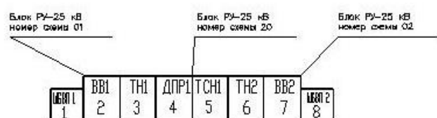
План расположения КРУ-25 кВ в капитальных зданиях
